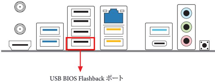
ASRock BIOS Flashback 機能を使用すれば、システムの電源を投入せずに、CPU がなくてもなくても BIOS を更新できます。
