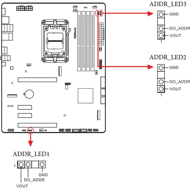
アドレスابل RGB LED ストリップをマザーボード上のアドレスابل LED ヘッダー (ADDR\_LED1 / ADDR\_LED2 / ADDR\_LED3) に接続します。
